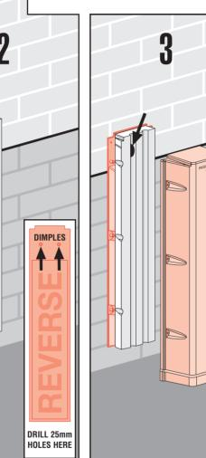
HOLE THROUGH WALL 25MM (AT LEAST 90MM) MDPE INSULATION (AT LEAST 32MM RECOMMENDED) SLEEVE HOCKEY STICK **ELBOW\* SUPPLY IN**
